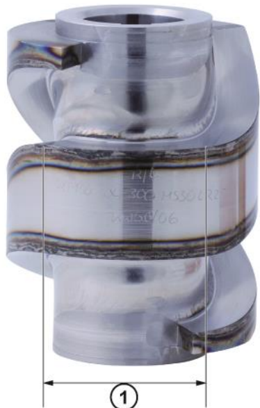
Fig. 12 Detalle: pendiente de leva (descanso)
