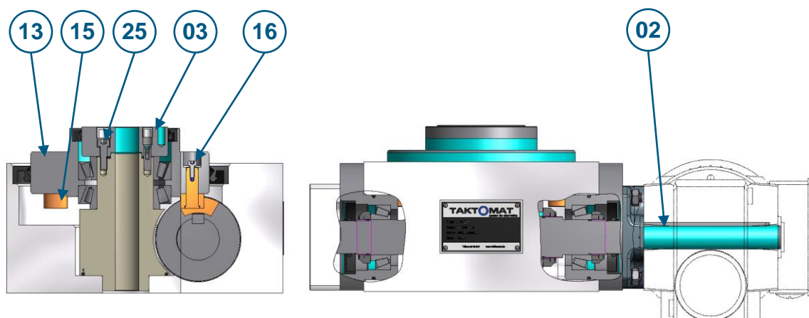
Fig. 39 Detalle sustitución de rodillo de leva tipo TT
